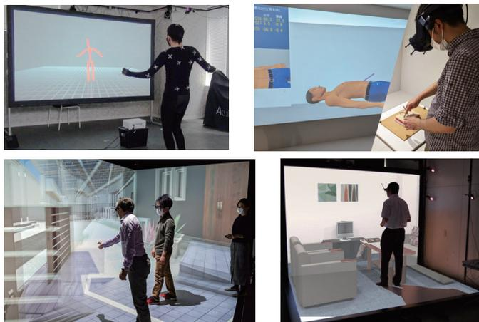
体験には光学式・磁気式等の 3次元位置計測システムによるヘッドトラッキングやモーションキャプチャ技術が不可欠で、マーカーやコイルセンサを体に装着する必要があります。
